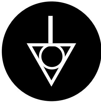
Mise à terre réseau
